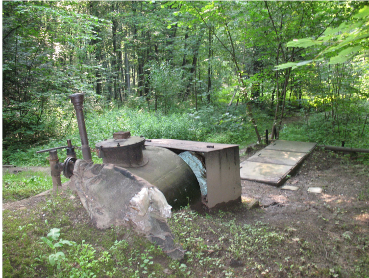
Ryc. 9. Zbiornik ropy naftowej; teren Zakładu Górniczego; strefa zagrożenia pożarowego i wybuchem. Gm. Iwonicz-Zdrój, woj. podkarpackie.
