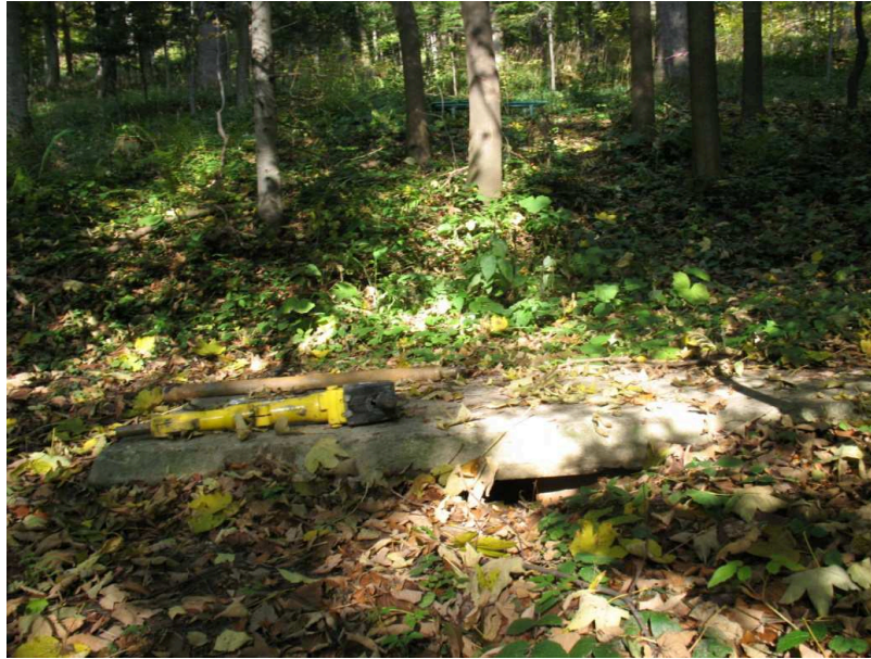
Ryc. 21. Stanowisko badań Nr 3. Kopanka z wodą i ropą nakryta przez leśników płytą betonową; wyraźnie widoczna szczelina – emisja z wnętrza kopanki (na powierzchni płyty złożone są narzędzia wiertnicze). Gm. Iwonicz-Zdrój, woj. podkarpackie, 2011.
