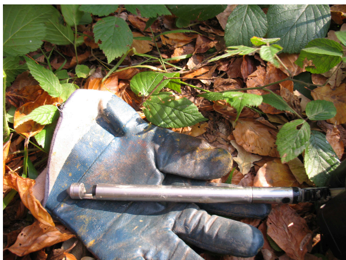
Ryc. 38. Stanowisko badań Nr 4. Sonda miernika grubości węglowodorów do pomiaru występowania wody i substancji węglowodorowych w otworze wiertniczym. Gm. Iwonicz-Zdrój, woj. podkarpackie, 2011.
