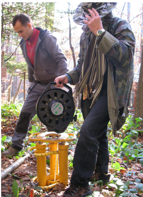
Ryc. 37. Stanowisko badań nr 4. Miernik grubości węglowodorów – pomiar głębokości, na której występuje woda w celu sprawdzenia, czy występują też substancje węglowodorowe (miernik grubości węglowodorów typ HS-1, Kanada). Gm. Iwonicz-Zdrój, woj. podkarpackie, 2011.
