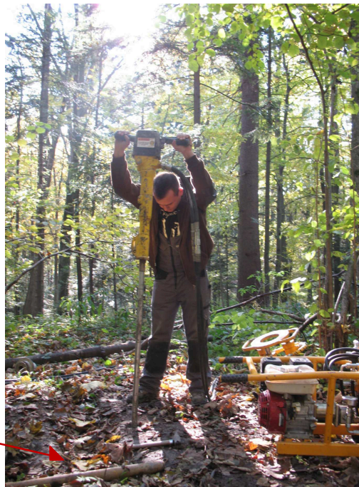
Ryc. 31. Stanowisko badań Nr 2. Koryto emisji wody; wiercenia geologiczno-inżynierskie w celu oceny profilu geologicznego i pobrania próbek gleby do badań laboratoryjnych wykonuje G. Tuleja – praca wymagająca siły fizycznej, wytrzymałości i cierpliwości. Gm. Iwonicz-Zdrój, woj. podkarpackie, 2011.
