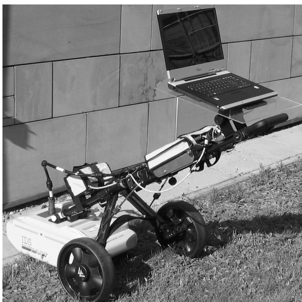
Ryc. 18. Georadar RIS, typ IDS-DUO-V.02.00.001. Włochy 2007.
