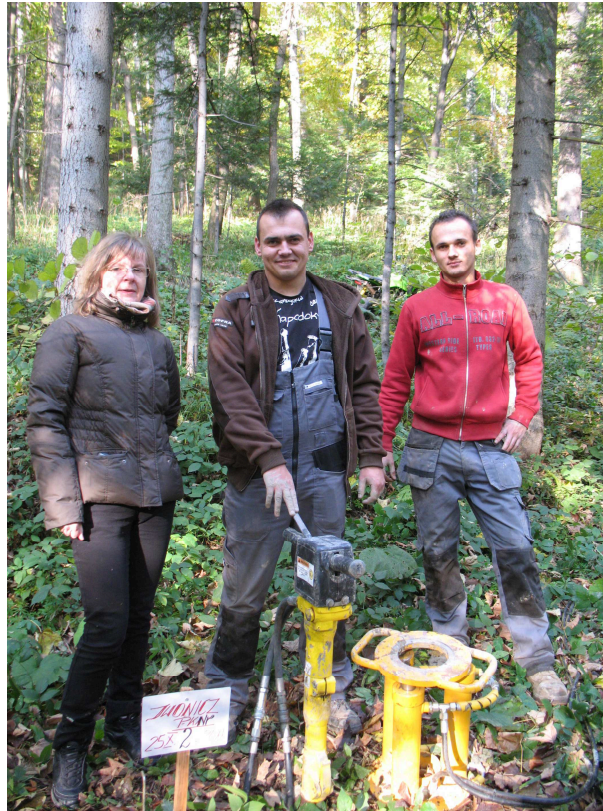
Ryc. 32. Stanowisko badań Nr 3. Wiercenia geologiczno-inżynierskie, w celu oceny profilu geologicznego i pobierania próbek gleby do badań laboratoryjnych; na zdjęciu Ewa J. Lipińska – kierownik projektu badawczego, w środku G. Tuleja, z prawej strony W. Tuleja. Gm. Iwonicz-Zdrój, woj. podkarpackie, 2011.
