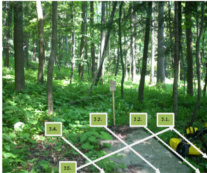
Rys. 2. Stanowisko badań nr 3. Schemat rozmieszczenia georadarowych profili pomiarowych [13], zdjęcie B. Rajchel
