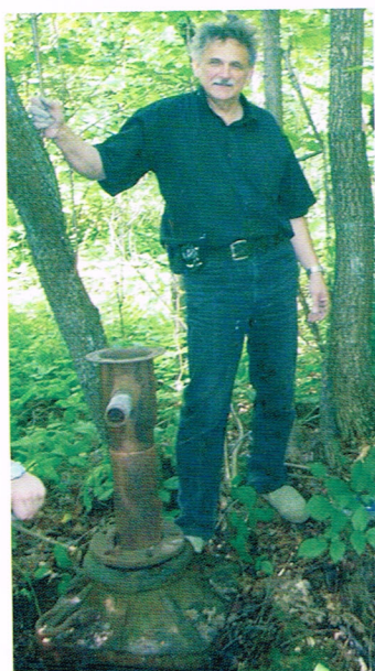
Ryc. 8.1.4. Kopanka pogłębiona metodą wiertniczą, zakończona zdekompletowaną głowicą do samoczynnego wypływu ropy naftowej z lat 1875-1939, Ropianka 2009 (kopankę prezentuje: doc. dr inż. Stanisław Rymar, PWSZ w Krośnie) [34]
