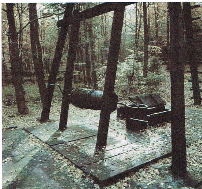
Fot. 1. Kopanka Franek z 1860 roku; zabezpieczona studnia kopana w celu poszukiwania i eksploatacji ropy; Skansen Muzeum Przemysłu Naftowego im. Ignacego Łukasiewicza w Bóbrce k/Krosna.
