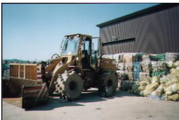
Zdjęcie 5. Element wyposażenia technicznego składowiska – sypcharko-zagęszczarka
