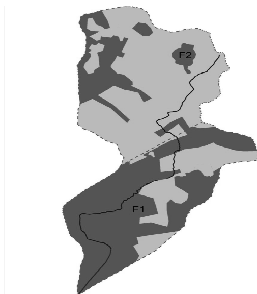
Rys. 5. Rozmieszczenie terenów uszczelnionych (ciemno szare powierzchnie) na obszarze zlewni potoku Rozrywka
