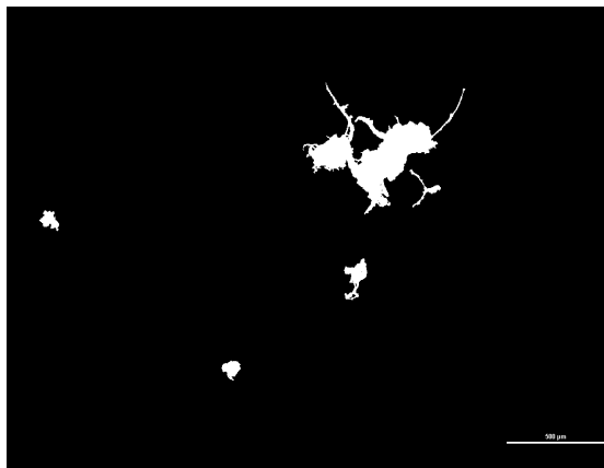
Rys. 4. Obraz binarny agregatów i nitek
